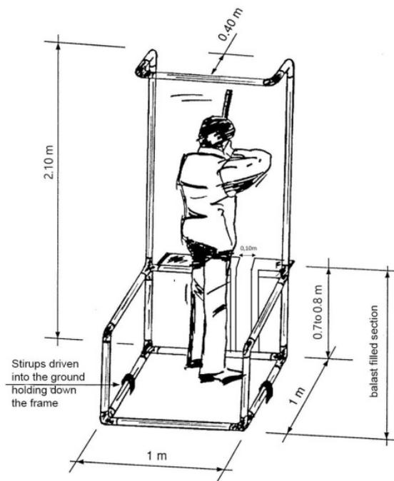
Стрілецький номер, виготовлений з кольорових ПВХ-трубок діаметром 50 мм (прямі трубки + з'єднуючі коліна).
